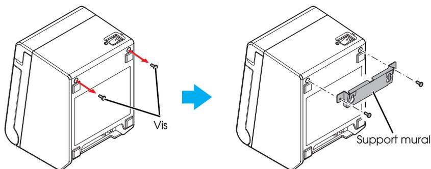
4. Aligned les orifices du support mural avec les vis installées dans le mur et accrochez l'imprimante de façon sûre.
