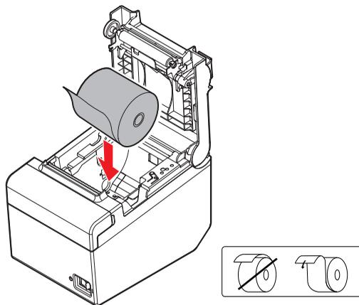
3. Немного вытяните бумагу, после чего закройте крышку рулона бумаги. Когда питание принтера включено, бумага в рулоне автоматически отрезается.
